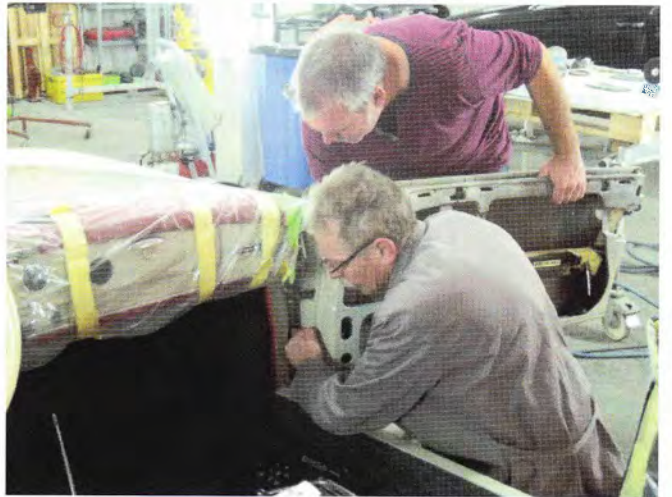
5. Montage der Türen
